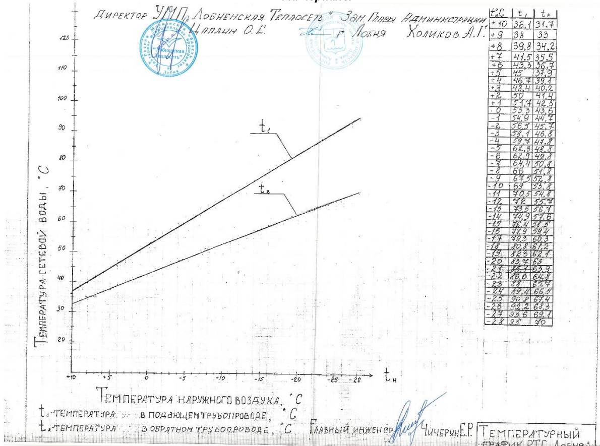
Рисунок 3 – Температурный график от котельной РТС «Лобня»
